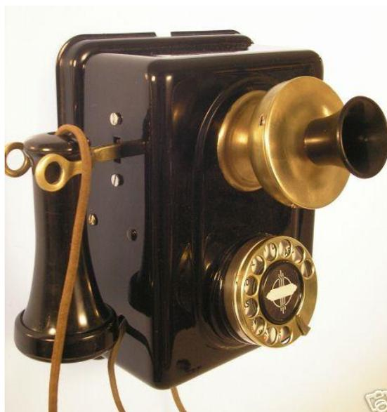
El teléfono de Bell constaba de un transmisor y un receptor unidos por un cable metálico conductor de la electricidad. Las vibraciones producidas por la voz en la membrana metálica del transmisor provocaban, por medio de un electroimán, oscilaciones eléctricas que transmitidas por el cable, eran transformadas por el electroimán del receptor en vibraciones mecánicas, que a través de una membrana reproducían el sonido emitido desde el emisor.
