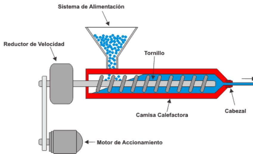
Si modificamos tanto la forma de las boquillas, como el sistema de arrastre, podemos obtener distintos productos finales: tubos, filmes, láminas y planchas, recubrimientos, y formas especiales que tienen relación con la forma de la boquilla.
