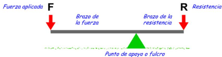
El funcionamiento de una palanca se rige por la Ley de la Palanca. La Ley de la Palanca es una relación que expresa que “el producto de la fuerza aplicada por su brazo (distancia entre el punto de aplicación de la fuerza y el punto de giro) es igual al producto de la resistencia por su brazo”.
